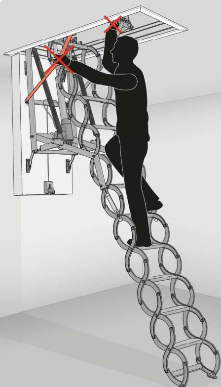
**Montáž schodů a jejich použití je nutno provádět v souladu s montážním návodem a návodom k použití. Bezpečnost použití závisí na provedení všech činností uvedených v montážním návodu a na použití schodů v souladu se všemi body uvedenými v návodu k použití.**
